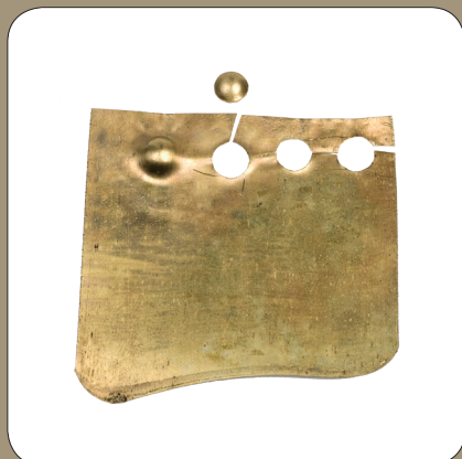
Izbijanje i izrezivanje iz lima. Puncturing and cutting out sheet metal.
