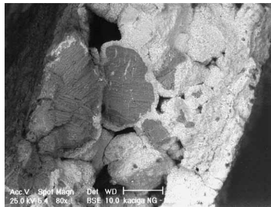
Slika 16 – SEM fotografija presjeka vanjskog korozivskog sloja
