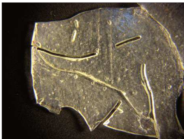
Sl. 12. Mikroskopski snimak procesa devetrifikacije, (povećanje 40x) Fig. 12. Microscopic picture of devetrification process (enlargement 40x).
