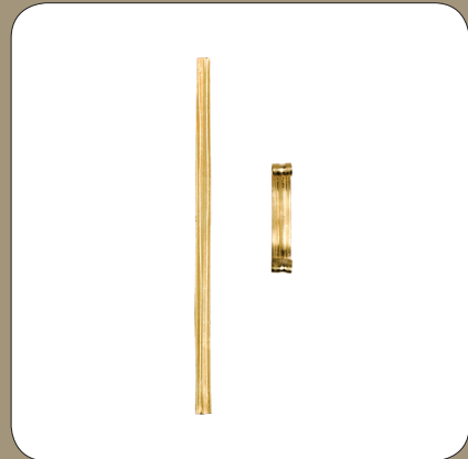
Izrezivanje vrpce i savijanje krajeva. Cutting strips and bending their ends.
