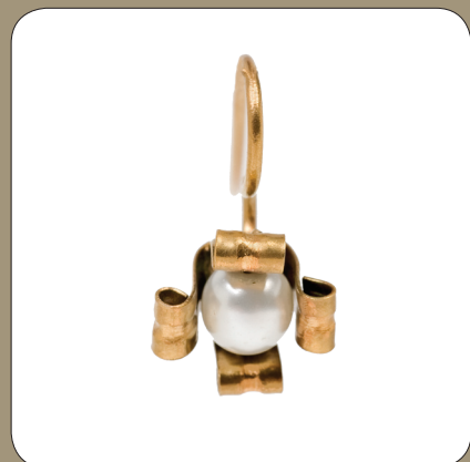
Savijanje vrpca prema veličini bisera. Bending the strips to match the size of the pearl.
