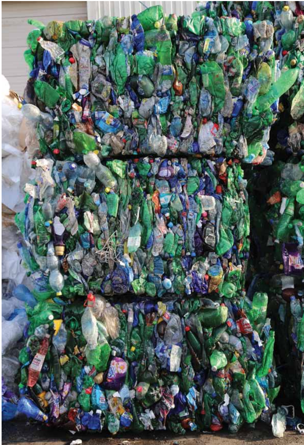
Sl. 1. Balirane separacije otpada u pogonu za reciklažu EKO-FLOR PLUS d.o.o (fotografirao: D. Gamulin).
