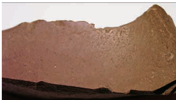
SI. 5.3 Brusne ogrebotine na suprotnim radnim ploham alata, a) grublje ogrebotine i b) finije ogrebotine
