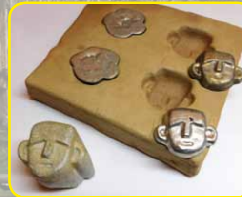
Keramički kalup i model te lijevani predmeti sa stariježeljeznodobnim motivom iz Kleinkleina (Štajerska, Austrija)
