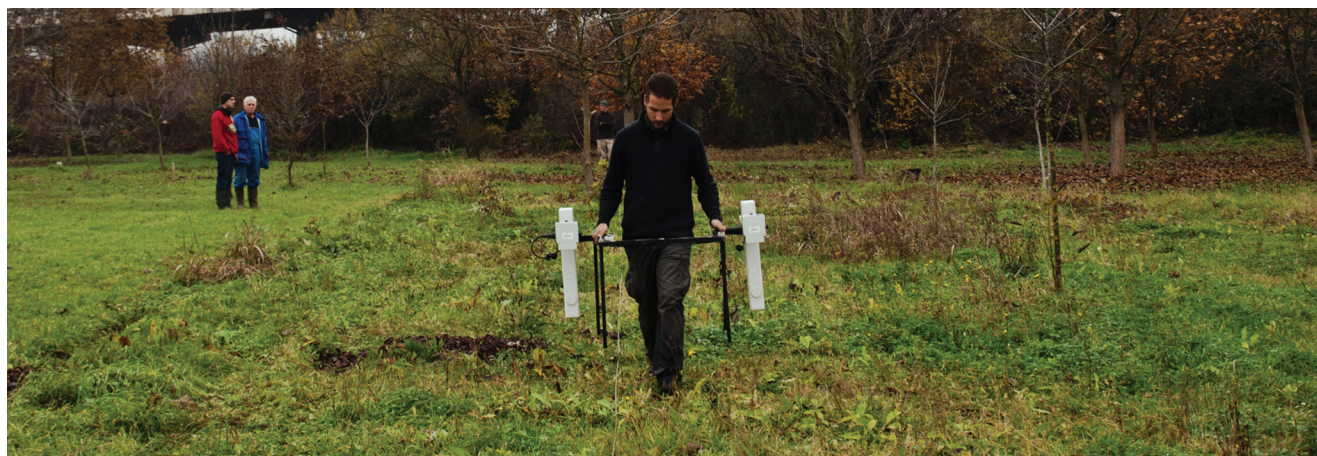
SLIKA 3. Geofizička magnetska prospekcija.
