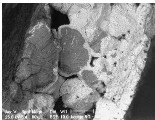
Slika 16 – SEM fotografija presjeka vanjskog korozivskog sloja
