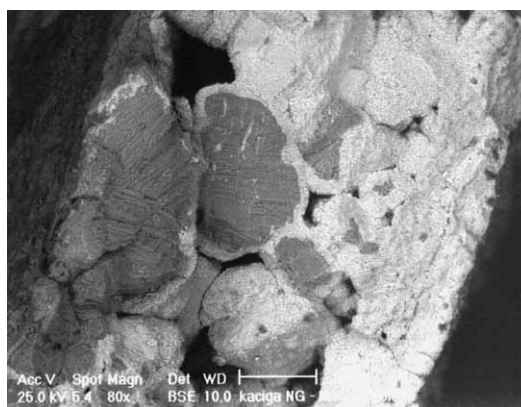
Slika 16 – SEM fotografija presjeka vanjskog korozivskog sloja
