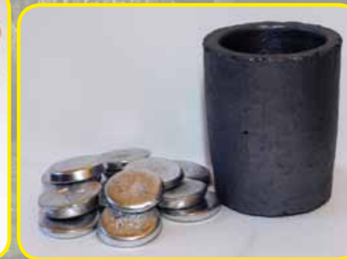
Kositrene pelete i grafitni lončić Rekonstruirana peć s kalupima
