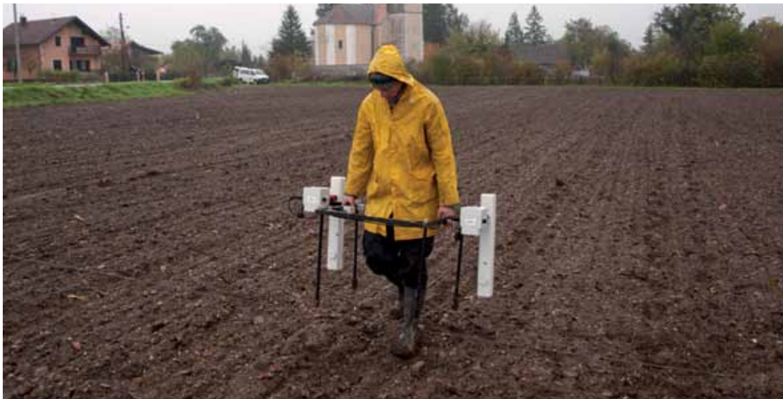
Abb. / Sl. 3: Geophysikalische Messungen 2012 mit Magnetik im Nordteil des Municipiums Andautonia-Ščitarjevo / Geofizička mjerenja 2012. g. s magnetskom metodom u sjevernom djelu municipija Andautonije-Ščitarjevo (Foto: ÖAI, A. Langendorf / snimio A. Langendorf, ÖAI)
